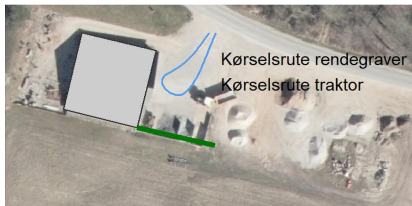
Kortet viser placering af 2 meter højt støjværm (hele kortet findes på bilag 7).
